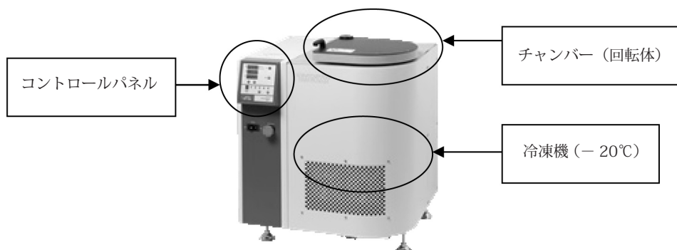
装置の構成：チャンバー，冷凍機（内蔵），コントロールパネルからなります。
